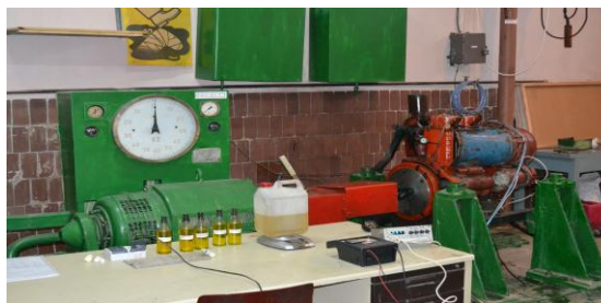
Рис. 1 Лабораторна установка для випробовування дизельного двигуна на альтернативних видах палива.
